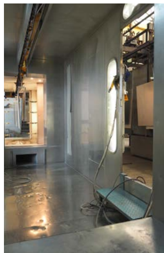
Die Pulverbeschichtung arbeitet mit je vier Pistolen pro Seite.
